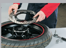
4. Retirar el disco de freno antiguo y limpiar la superficie de apoyo.
