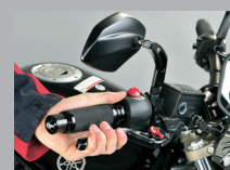
6. Comprobar el punto de contacto del freno y la libertad de movimiento de la rueda. Limpiar el disco de freno.
