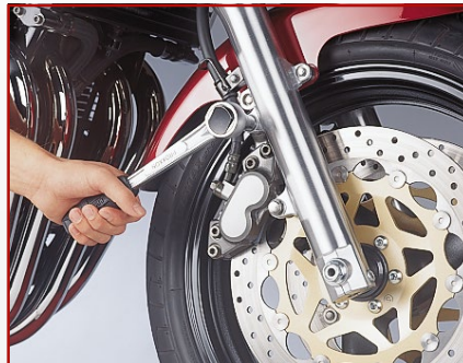
2a. Bremssattel abnehmen
