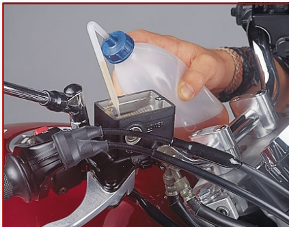
1. Eventuell etwas Bremsflüssigkeit absaugen
