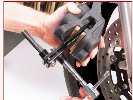
2b. Bremskolben zurückdrücken
