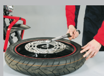
5. Neue Bremsscheibe aufsetzen und Befestigungsschrauben anziehen.
