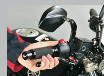
6. Druckpunkt der Bremse und Freigängigkeit des Rades überprüfen. Bremsscheibe reinigen.
