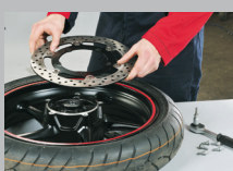
4. Alte Bremsscheibe abnehmen und Auflagefläche reinigen.
