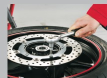
3. Befestigungsschrauben der Bremsscheibe lösen.
