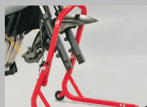
2. Radachse lösen und Rad entnehmen.
