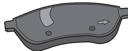
Тормозная колодка с указанием направления установки и выемкой на опорной пластине колодки
